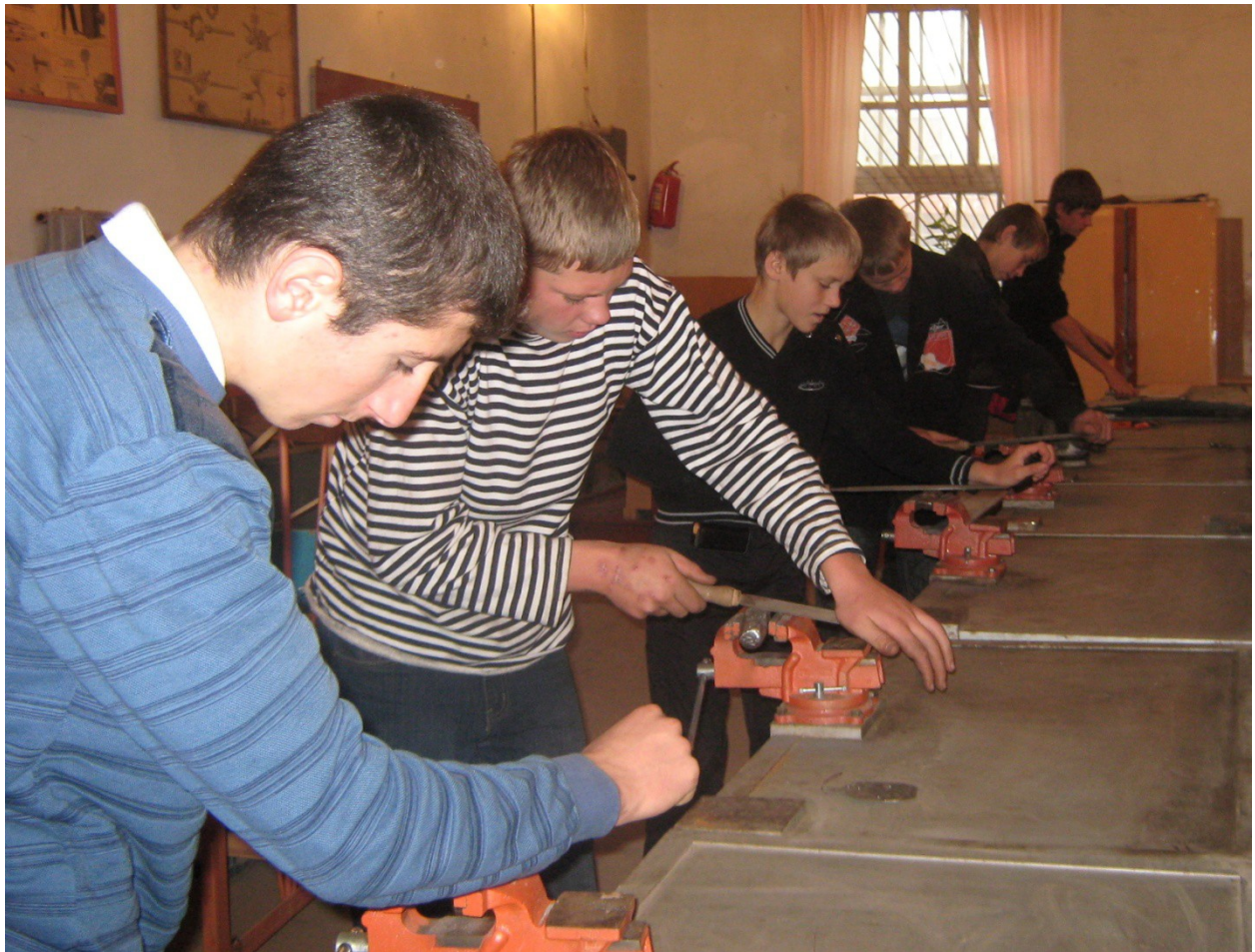
Отрабатываем приёмы опилование поверхностей, расположенных под углом.
