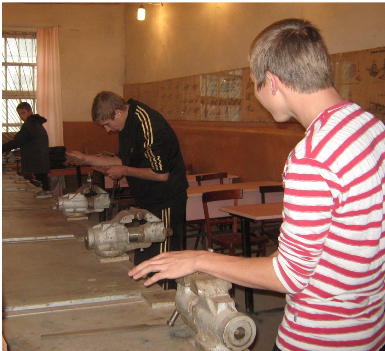
Мы с обучающимися отрабатываем приёмы рабочих движений и балансировка напильника
